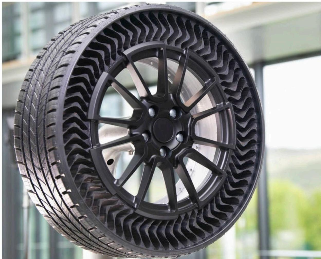
車胎內的 V 型結構，能增加輪胎彈性和避震效果，最快能開到時速 210 公里。
